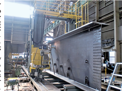
I桁腹板矯正装置
