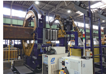
柱大組立溶接ロボットで効率的に鉄骨を製作
